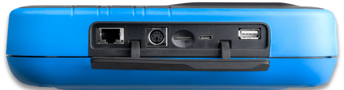
Stranska priključna plošča z Ethernet priključkom, 6-pinskim Mini-DIN priključkom, rezo za microSD kartico, priključkom USB Type-C in priključkom USB Type-A.
